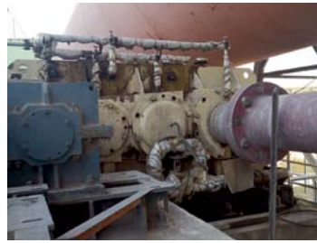
Рис. 2. Редуктор ЦЗ-770 главного привода вращающейся печи размерами \varnothing 4,8 \times 72 м на предприятии ООО «Азия Цемент»
