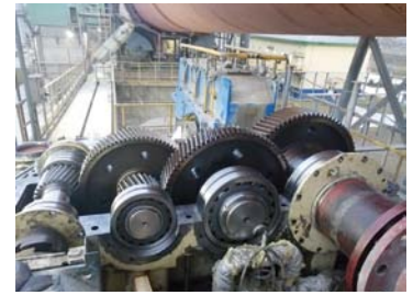
Рис. 3. Редуктор ЦЗ-770 главного привода, установленный на вращающейся печи размерами \varnothing 4,8 \times 72 м ООО «Азия Цемент»
